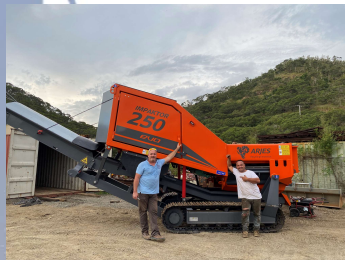
Un broyeur Universel et mobile – qui permet de mutualiser la réduction des volumes sur d’autres déchets et de limiter les transports - 40 Millions Xpf
